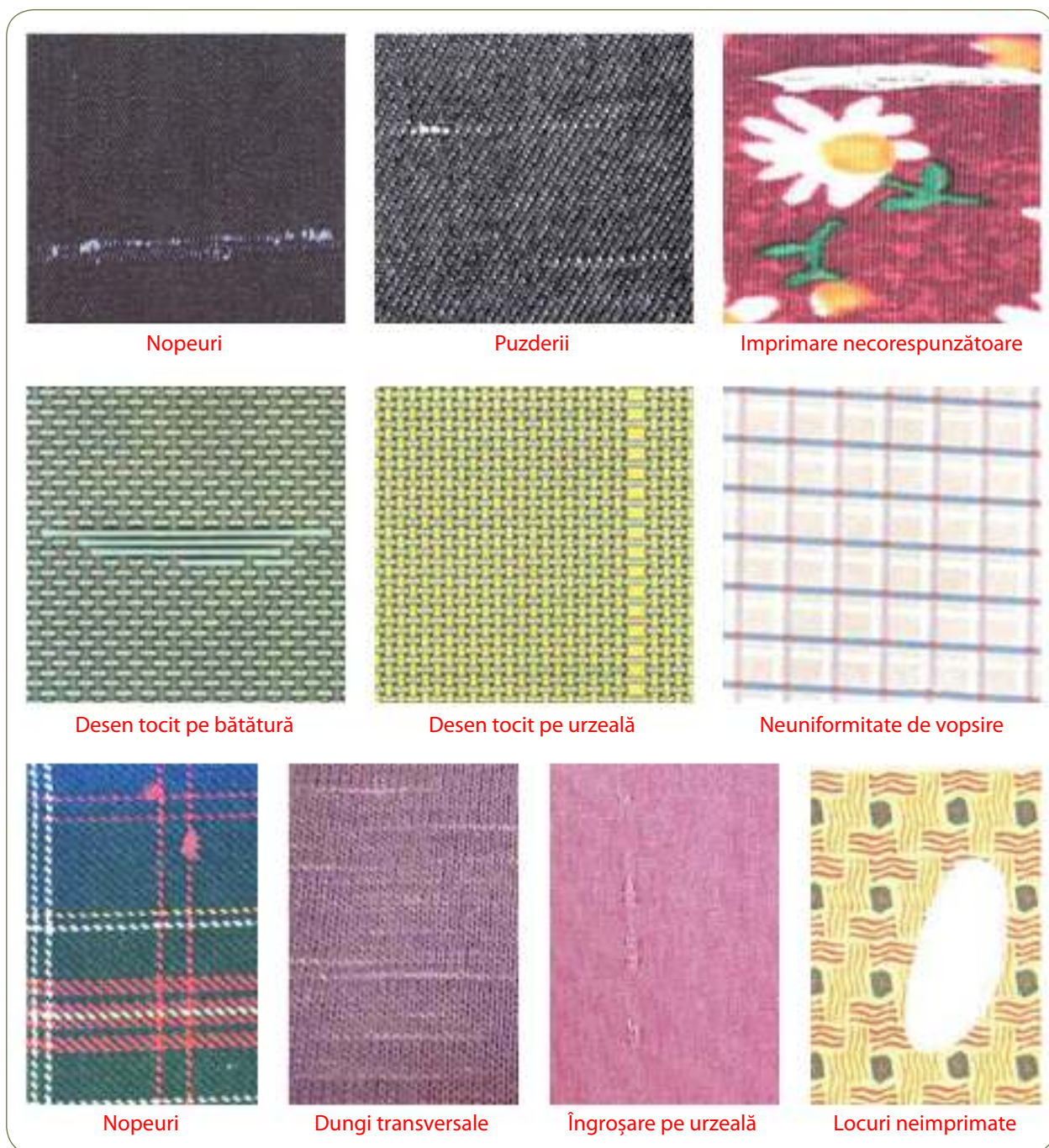
Figura 4.1. Tipuri de defecte
